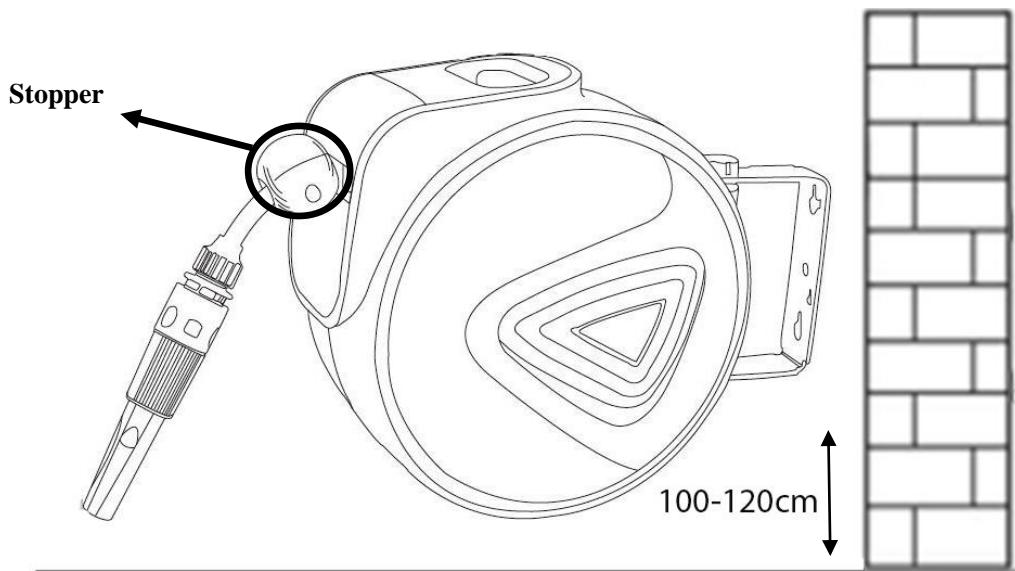
Det anbefales at installere monteringsbeslaget 100-120cm fra gulvet.
