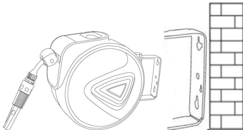
Bor 2 x 8 mm huller, så de passer til hullerne i monteringsbeslaget.
